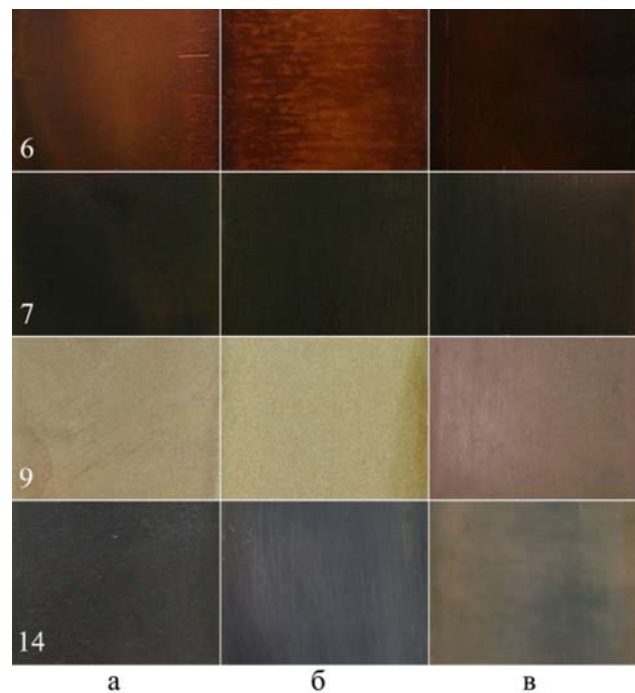
Рис. 3. Образцы патины, полученные в растворах с различной молярной концентрацией карбоната гидроксомеди (6–0,9; 7–0,45; 9–1,35; 14–0,68 (моль/л)) на латуни марок: а – реставрационный образец; б – Л-63; в – ЛС59-1
