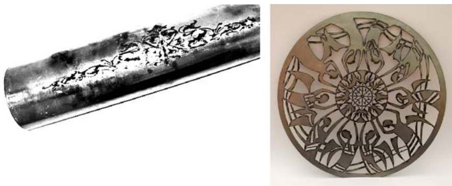
Рис. 6. Слева – образец лазерной резки, справа – образец плазменной резки
