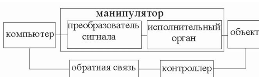
Рис. 2. Блок-схема работы робота-манипулятора
