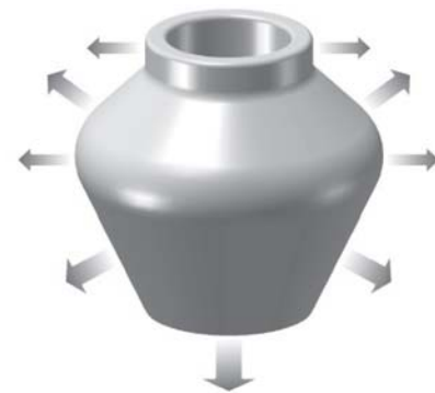
Рис. 3. Осевая симметрия формовочных усилий при шликерном литье в пористые формы
