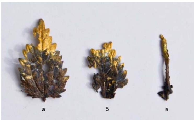
Рис. 8. Экспериментальные отливки листьев крапивы в зависимости от типа покрытия: а – аэрозольная краска и воск; б – только аэрозольная краска; в – полоска воска
